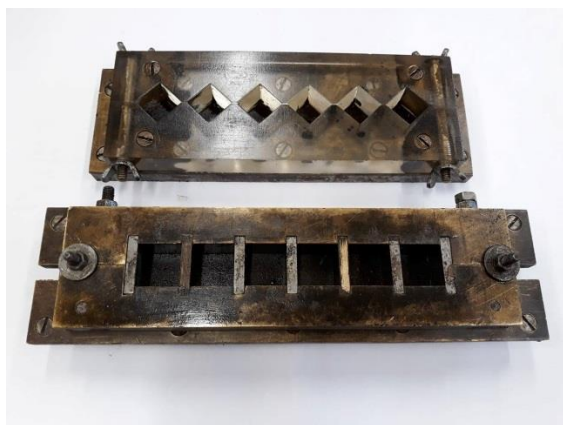
Formy na výrobu zkušebních 6ti zkušebních vzorků o rozměru a = 20 \times 20 \times 20 mm 18 \times 18 \times 18 mm.
