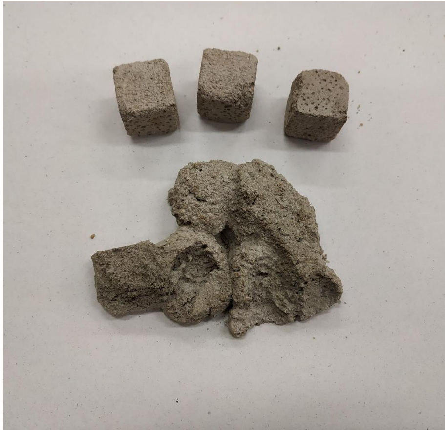
Obr. 8: Destrukce vzorků ve směsi cement-silikagel při hydrotermální úpravě
